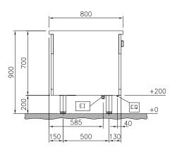
Electrical inlet (power) Equipotential screw
